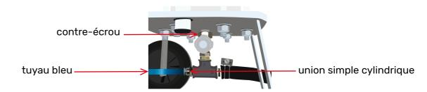
8-1 Débranchez le tuyau bleu en appuyant sur la rondelle de la pièce (union simple cylindrique).
