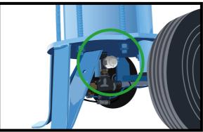
Les réglages de débit d'abrasif se font avec la vanne métrique (5)
