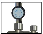
Les réglages d'air se font avec le détendeur au dessus du manomètre. Tirez, tournez pour faire varier la pression sur le mano puis rappuyez.
