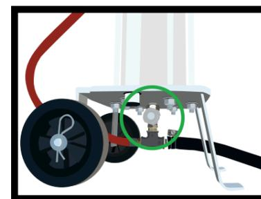
Les réglages de débit d'abrasif se font avec la vanne métrique (7) **(Ne jamais ouvrir la vanne à fond, ouvrir petit à petit)**
