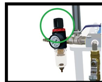
Les réglages d'air se font avec le détendeur au dessus du manomètre.
