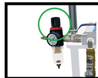
Les réglages d'air se font avec le détendeur au dessus du manomètre. Tirez, tournez pour faire varier la pression sur le mano puis rappuyez.
