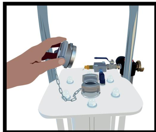
Vous pouvez remplir la cuve jusqu'à voir l'abrasif au niveau du conduit du bouchon
