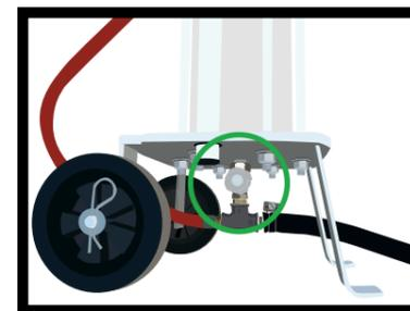
Les réglages de débit d'abrasif se font avec la vanne métrique (7) **(Ne jamais ouvrir la vanne à fond, ouvrir petit à petit)** Pour régler le débit, ouvrir ou fermer la vanne d'abrasif petit à petit. Info: Vous devez à peine voir l'abrasif sortir. Pour augmenter l'efficacité de travail augmenter le débit d'air plutôt que le débit d'abrasif.
