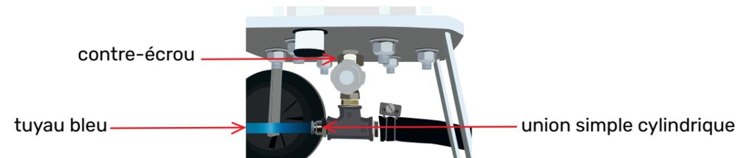
7-1 Débranchez le tuyau bleu en appuyant sur la rondelle de la pièce (union simple cylindrique).
