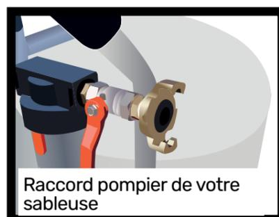
**Info :** Utilisez un tuyau d'air de minimum 13 mm intérieur pour le raccordement entre l'aérogommeuse et le compresseur. (Avec un tuyau plus petit il y a un risque qu'il n'y ait pas suffisamment d'air qui arrive à la sableuse).
