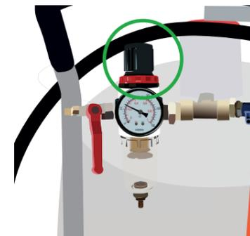
Les réglages d'air se font avec le détendeur au dessus du manomètre.
