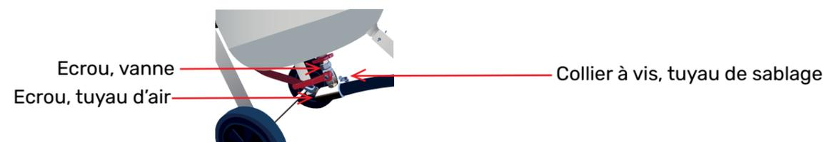
7-1 Démontez le collier à vis du tuyau de sablage avec un tourne vis et une clé et enlevez le tuyau de sablage.
