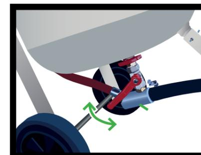
Les réglages de débit d'abrasif se font avec la vanne d'abrasif (5)
